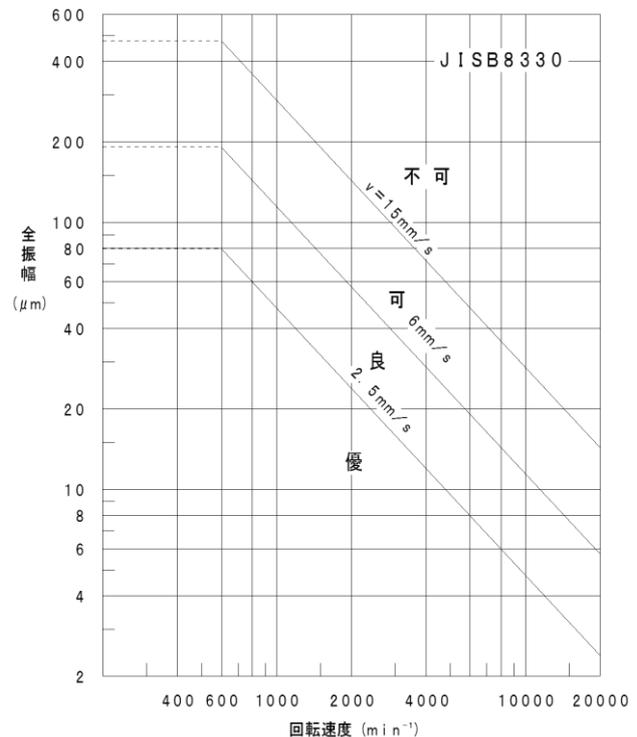
参考 : 全振幅  $a$  ( $\mu\text{m}$ ) と振動速度  $v$  ( $\text{mm/s}$ ) の関係は、次のとおりである。
