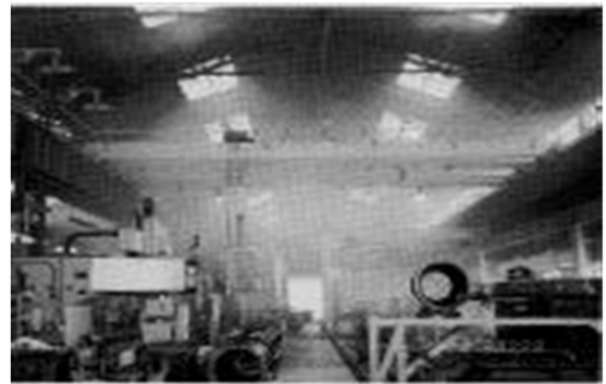
発煙テスト(換気設備の運転5分後)
