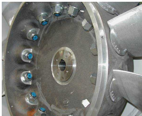
図6 ファンロータをシャフトの前に引き出し
