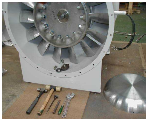
図4 モータ軸座金を取外す
