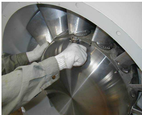
図1 ノーズ取付ボルトを外す
