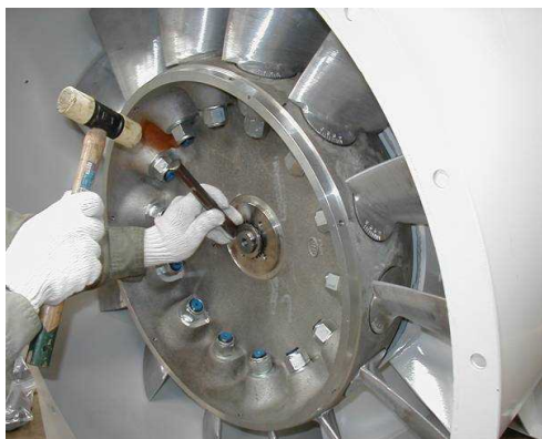
図3 モータ軸ナットを緩める
