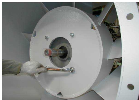
図7 モータ取付ナットを緩める
