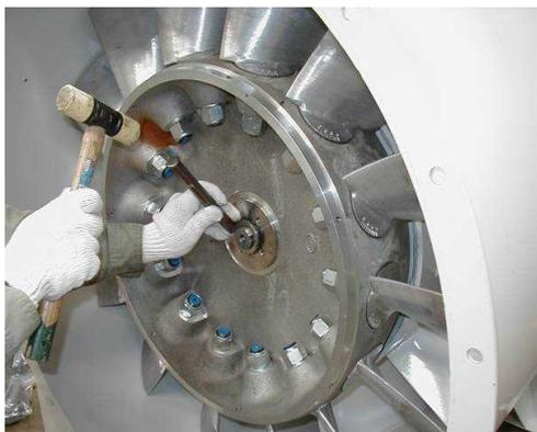
図3 モータ軸ナットを緩める
