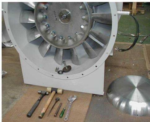
図4 モータ軸座金を取外す
